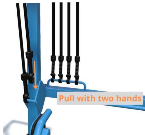
Figure 6 : Installation des élastiques
