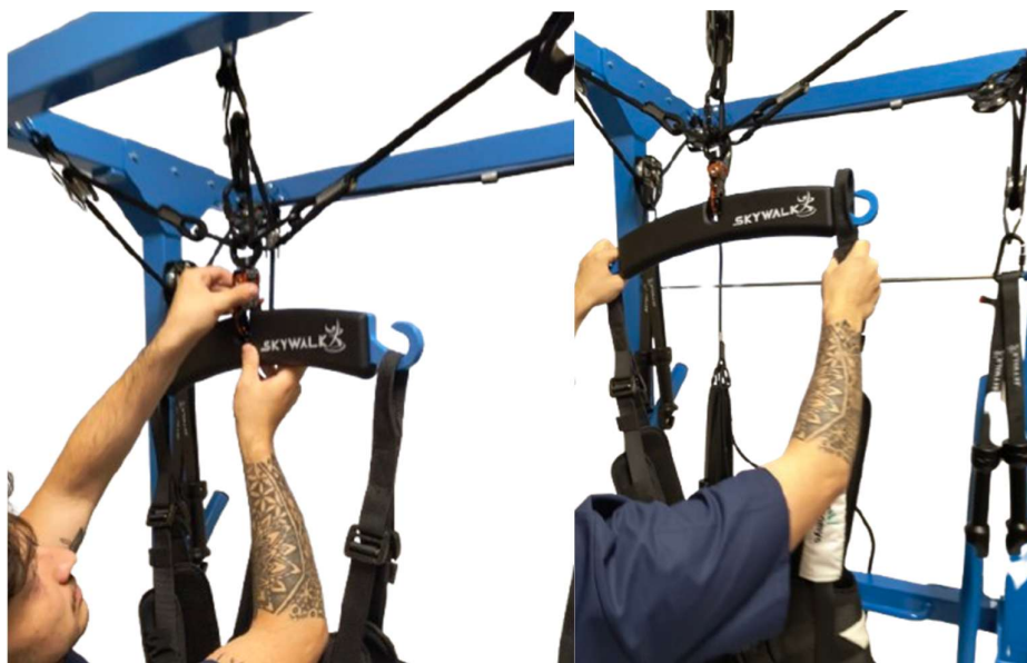
Figure 4: Attachement de la barre de suspension (gauche) and attachement du harnais à la barre de suspension (droite)
